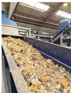
CHIMIREC vient d'équiper son site de Beaucaire d'une chaîne de préparation de CSR qui permet de valoriser jusqu'à 65 000 tonnes de déchets non dangereux par an. Véritable innovation, elle s'inscrit comme une alternative aux énergies fossiles : 1 tonne de CSR équivaut à une ½ tonne de pétrole.
