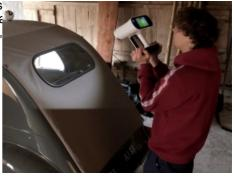
Ils ont ensuite utilisé deux scanners avec des propriétés et des fonctions différentes. Le scanner <u>Artec Ray</u>, un scanner laser 3D longue distance de haute précision, idéal pour la capture précise de gros objets, a permis d'obtenir une géométrie parfaite grâce à sa couverture en 360° et ses images en haute définition.
