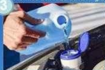
3 Remise à niveau du lave-glace
